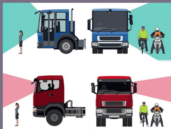
圖 58: 司機在傳統貨車（紅色）與「Direct Vision HGV」（藍色）能夠直接看見的視野比較（圖片來自倫敦運輸局） 70
