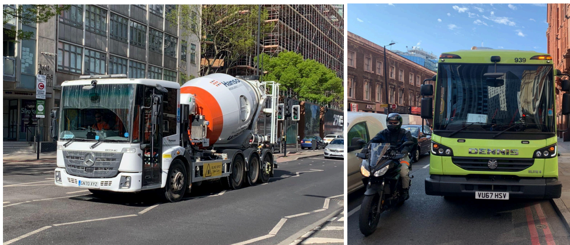
倫敦街頭所見的「Direct Vision HGV」，可見配有特低擋風玻璃和全透明車門設計
