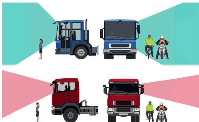
司機在傳統貨車（紅色）與「Direct Vision HGV」（藍色）能夠直接看見的視野比較 15
